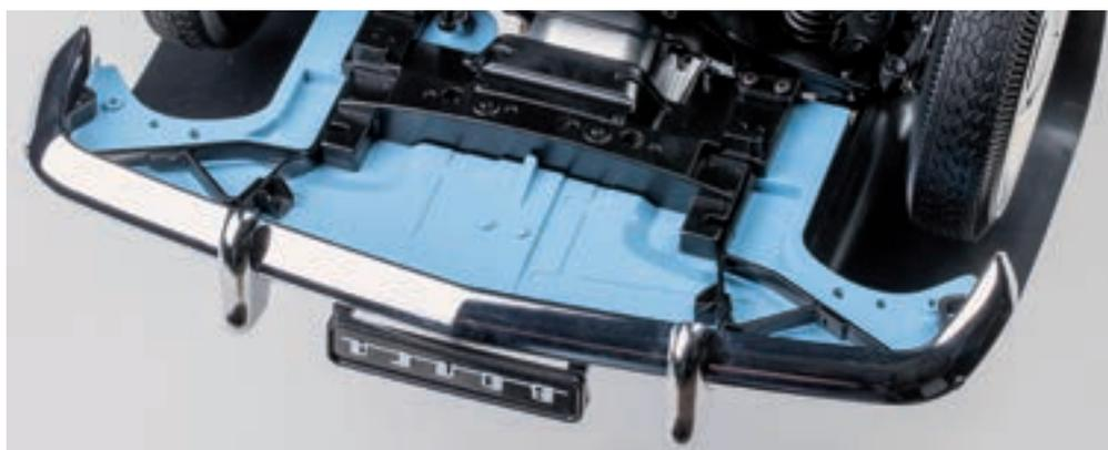
Зафиксируйте установленный бугер шестью винтами 1,7×4 (АМ). По два винта закрепите в правом и левом передних лонжеронах модели и по одному винту — в крепежных уголках каждого кронштейна переднего бугера.
