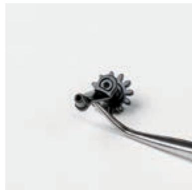
Перед сборкой рулевого редуктора проверьте качество шлицевого соединения сошки рулевого управления с шестерней. При необходимости удалите излишки краски с вала шестерни. При сборке модели помните, что сошка, установленная на валу, должна быть направлена вперед по ходу движения модели.
