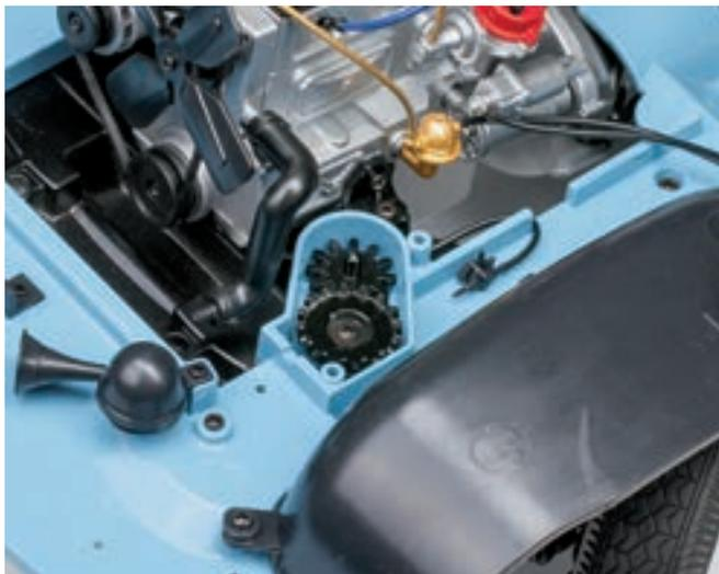
В корпус рулевого редуктора вставьте шестерню вала сошки. Расположите ее в отверстии корпуса ближе к двигателю модели. Вал шестерни с фаской должен быть направлен вниз. Рядом с установленной шестерней вала сошки поместите корончатую промежуточную шестерню. Закрепите промежуточную шестерню винтом 2,0×3 с пресс-шайбой (GM). В случае, если он свободно болтается в отверстии, используйте винт 2,3×4 с пресс-шайбой (DM).
