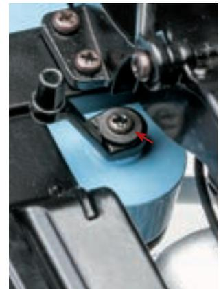
С нижней стороны шасси модели установите сошку рулевого управления на вал шестерни. Совместите центровочные элементы деталей и закрепите сошку при помощи винта 2,0×3 с пресс-шайбой (GM).
